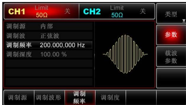
此时可以利用多功能旋钮和方向键的配合进行设置。您也可以再次按**参数**→**调制度**软键后通过数字键盘输入数字80再按**%**软键来完成对调制深度的设置。
