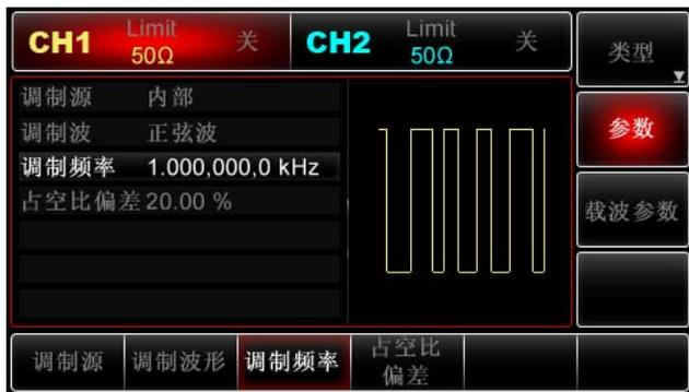
此时可以利用多功能旋钮和方向键的配合进行设置。您也可以再次按**参数**→**占空比偏差**软键后通过数字键盘输入数字40再按**%**软键来完成对占空比偏差的设置。
