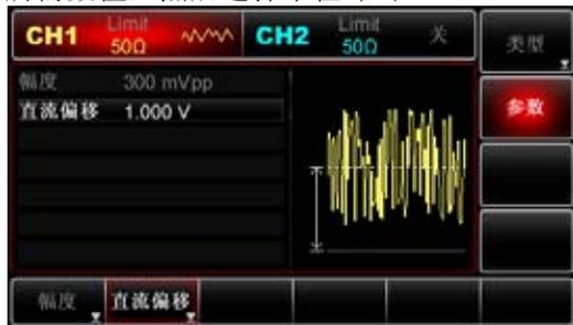
注意：多功能旋钮和方向键的配合也可进行此参数设置。
