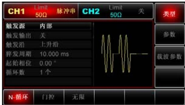
猝发周期（脉冲串周期）仅适用于N循环模式，定义为从一个脉冲串开始到下一个脉冲串开始的时间，当触发源选择为外部和手动触发时，参数列表会隐藏猝发周期（脉冲串周期）选项。猝发周期（脉冲串周期）的可设置范围为1 $\mu$ s~500s，默认“猝发周期”时间为10ms，若要进行更改在选择脉冲串的类型为N循环后利用多功能旋钮和方向键的配合或依次按**参数**→**猝发周期**软键来完成更改。
