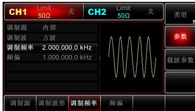
此时可以利用多功能旋钮和方向键的配合进行设置。您也可以再次按**参数**→**频偏**软键后通过数字键盘输入数字5再按**kHz**软键来完成对频率偏差的设置。
