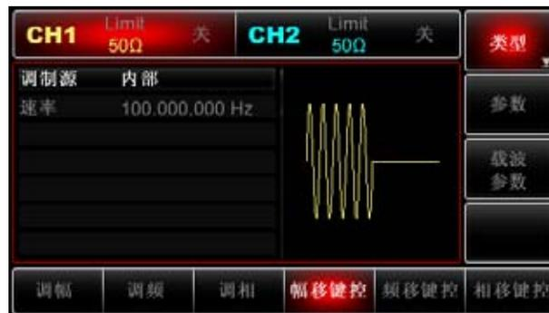
此时可以利用多功能旋钮和方向键的配合进行设置。您也可以再次按**参数**→**速率**软键后通过数字键盘输入数字300再按**Hz**软键来完成对ASK速率的设置。
