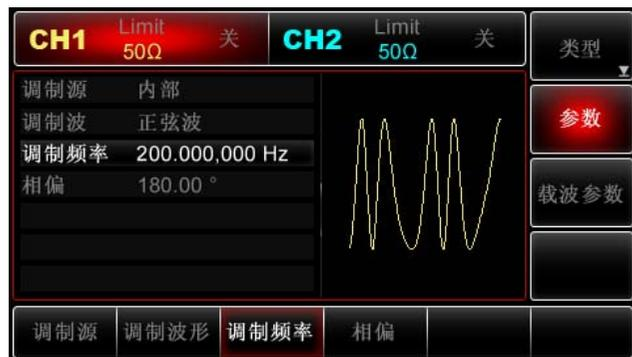
此时可以利用多功能旋钮和方向键的配合进行设置。您也可以再次按参数→相偏软键后通过数字键盘输入数字200再按 ° 软键来完成对相位偏差的设置。
