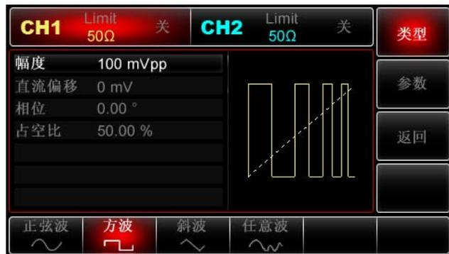
此时可以利用多功能旋钮和方向键的配合进行幅度设置。您也可以再次按**参数**软键，此时会弹出如下界面：
