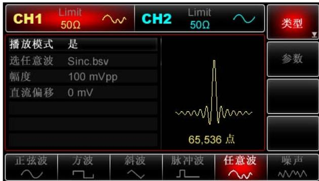
注\*：UTG2025A无逐点输出模式，是通过软件自动插值或抽点的方式以固定的长度（8192点）和参数列表中的频率输出任意波形。
